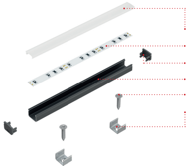
Axonometric projection before assembly using mounting clips and screws Rzut aksonometryczny przed montażem z wykorzystaniem uchwytów oraz wkrętów
